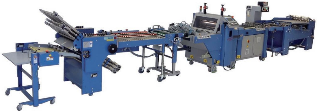
Produktionslinie bestehend aus vorgeschaltetem Rundstapelanleger, BSR 550 Servo, Überführung UEB 550 B und nachgelagertem Taschenfalzwerk.
