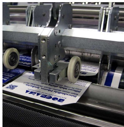
Ausbrechelemente für das Umlenken des Abschnittgitters und das Abgreifen der Produkte
